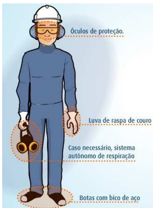
Figura 5 EPI's obrigatórios para o manuseio de cilindros e centrais
