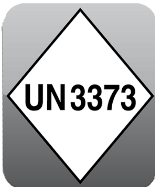
IMAGEM 1: Designação oficial de transporte para amostras classificadas como UN 3373: “substância biológica da categoria B”
